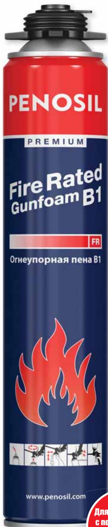
Огнеупорная профессиональная монтажная пена. Предназначена для герметизации, изоляции и монтажа конструкций с повышенным классом огнестойкости. Испытана на огнестойкость в соответствии с требованиями ГОСТ 30247.0-94. Предел огнестойкости EI 15 – EI 180. Соответствует европейскому стандарту EN 1366-4 и стандарту DIN 4102-1.
